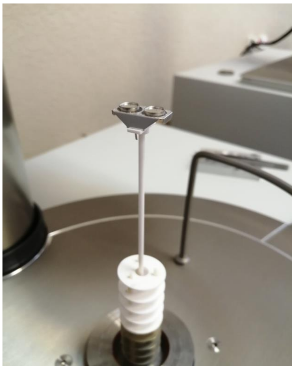
Рис. 4.5– ДСК держатель с платиновыми тиглями прибора Netzsch STA 449 F5 Jupiter
