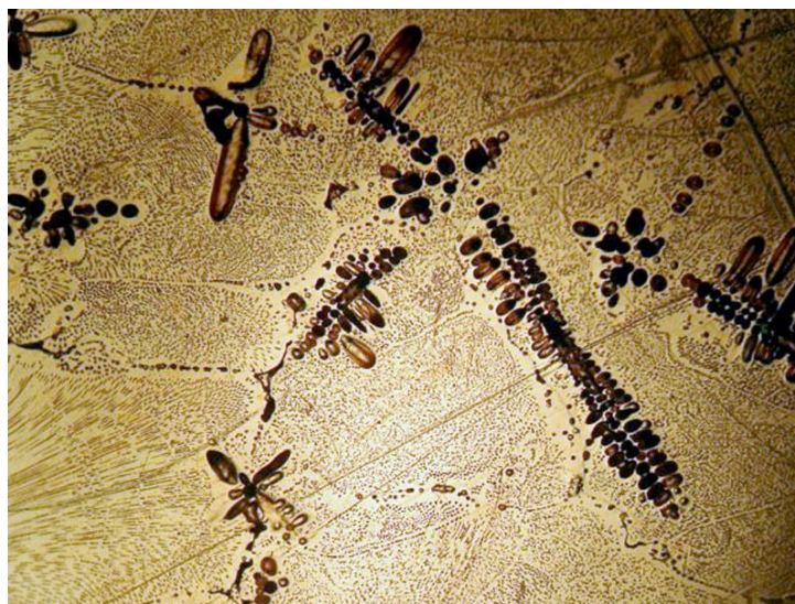
Рис. 3.3 Дендритные зёрна на металлографическом снимке
