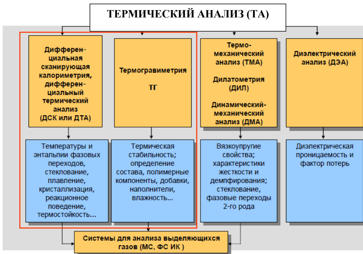
Рис. 4.1 – Схема методов термического анализа
