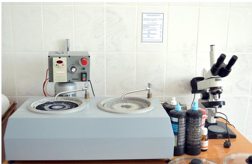
Рис. 3.2. Установка для приготовления металлографических шлифов
